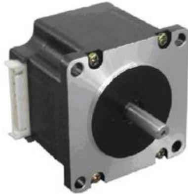
步进电机通过脉冲数控制转子的旋转角度，每个步进电机都有其固定的步距角，例如常见的 $1.8^\circ$ ，需要200个脉冲信号才能旋转一周。步进电机无碳刷，数字控制，误差不累计，过载性好，不会因为负载的变化而引起转速的变化。检验设备采用的步进电机一般都是永磁式，二相、五相系列。
